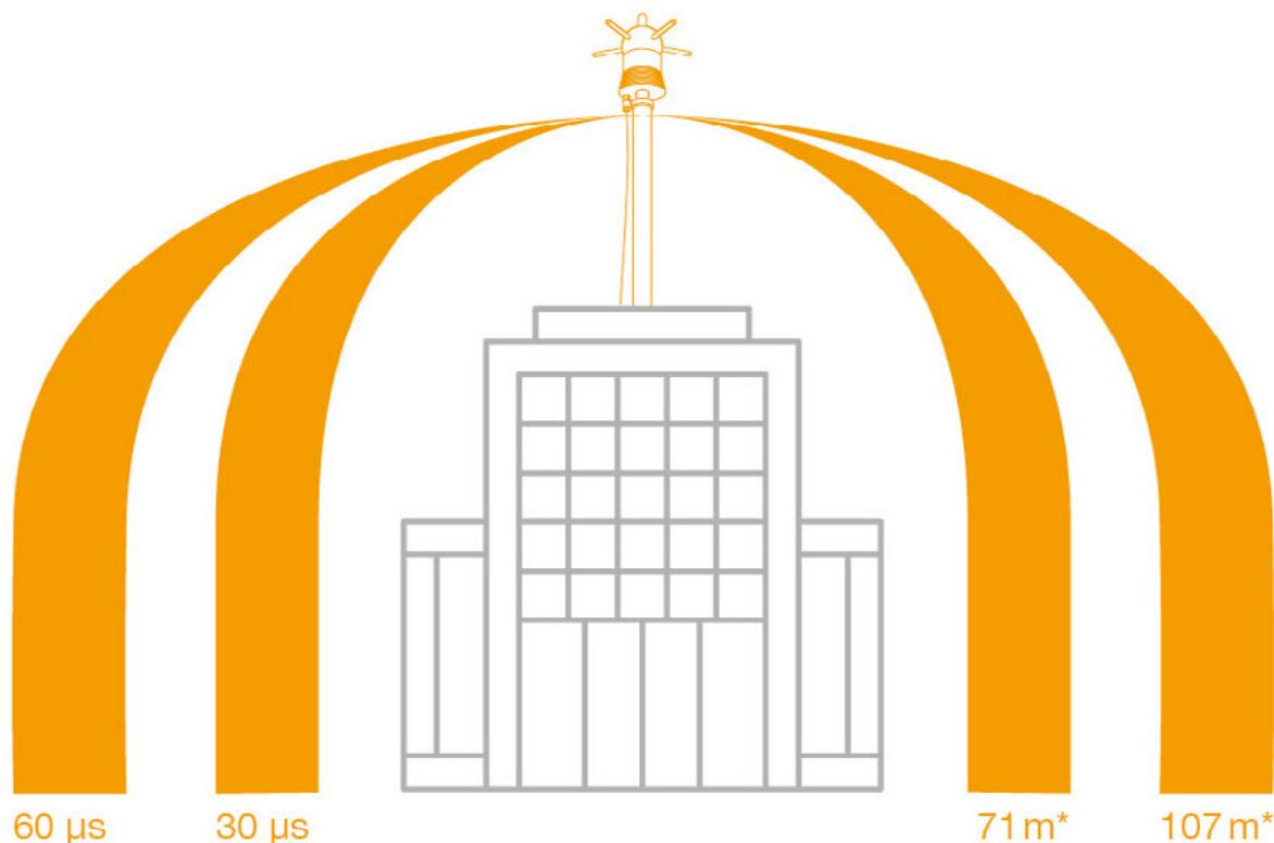
\*Exemple du rayon de protection à 5 m sous la pointe, en Niveau de protection IV.
