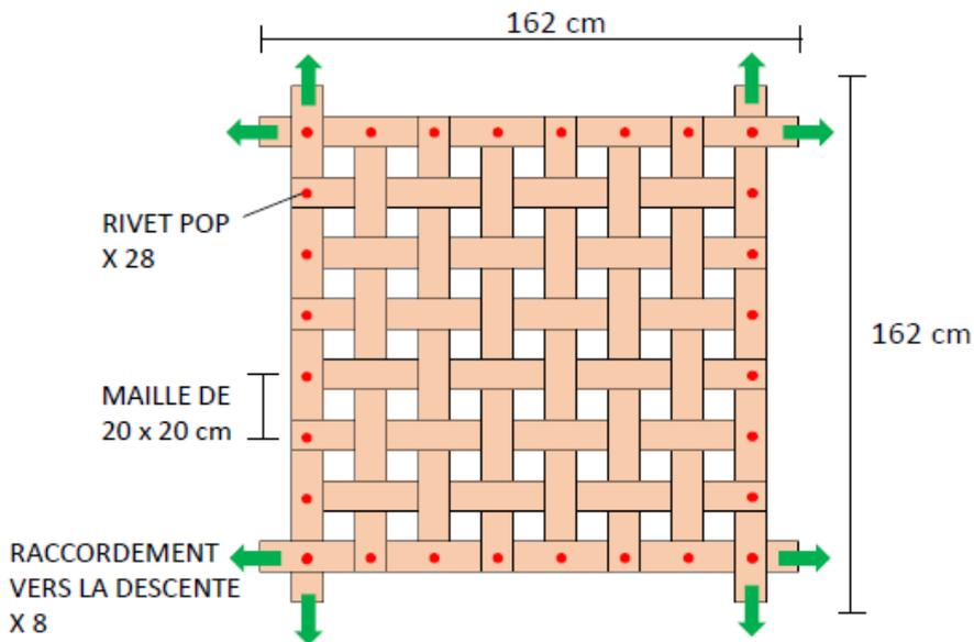
Exemple d'utilisation de 4 grilles de terre avec raccordement plat / plat vers la descente :
