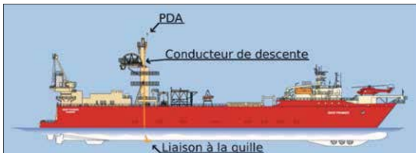
Figure 9 : Protection anti-foudre d'un navire câblé.
